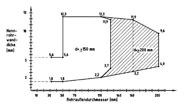
Rohre gemäß der Rohrgruppe B-3 (Rohre aus PE-HD, LDPE, PP, ABS, ASA, PE-X, PB, ...) Rohrgrößen innerhalb der Schraffur nur ohne Verwendung von Weichschaum-Streifen
