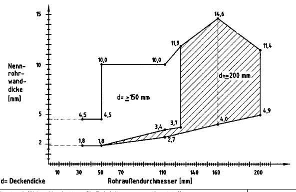
Feuerwiderstandsfähige Abschottung für Rohrleitungen aus Kunststoff
