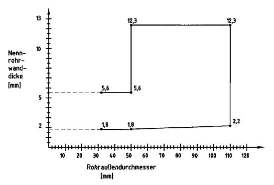
Rohre gemäß der Rohrgruppe B-1 (Rohre aus PE-HD, LDPE, PP, ABS, ASA, PE-X, PB, ...): Einbau in mindestens 10 cm dicke leichte Trennwände
