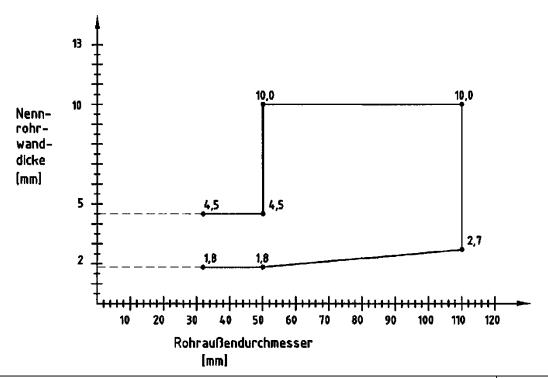
Feuerwiderstandsfähige Abschottung für Rohrleitungen aus Kunststoff "System IWM III plus"
