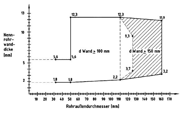
Rohre gemäß der Rohrgruppe B-2 (Rohre aus PE-HD, LDPE, PP, ABS, ASA, PE-X, PB, ...) Rohrgrößen innerhalb der Schraffur nur ohne Verwendung von Weichschaum-Streifen
